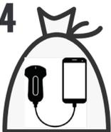
将保护罩套在整个仪器上用松紧带固定
